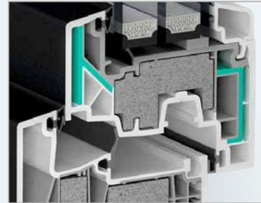
Stahlverstärkungen sind seit jeher ein fester Bestandteil der PVC-Fensterfertigung. Die neue proStratoTec Technologie ersetzt Stahl gegen glasfaserverstärkten Kunststoff und macht ihn somit überflüssig. Mit Hilfe einer innovativen Tri-Extrusion wird PVC Frischmaterial, Recyclat und glasfaserverstärkter Kunststoff gleichzeitig in ein Fensterprofil extrudiert.
